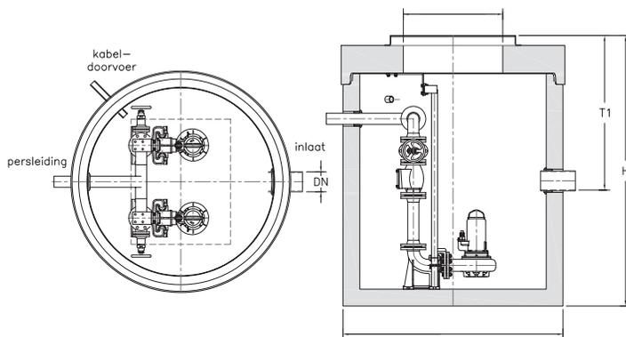
Voller Stolz präsentieren wir unsere neue Reihe von Pumpensümpfen und Pufferbehältern, die unsere bestehenden Reihen von Fett-, Öl-/Benzin- und Parallelplattenabscheidern ergänzt. Wir stellen diese Produkte in unserer Fabrik aus rundem oder rechteckigem vorgefertigtem Stahlbeton her. Diese Pumpensümpfe sind auch in HDPE und Edelstahl AISI 304/316 (geeignet für Anwendungsbereiche mit hohen Wassertemperaturen) erhältlich.
